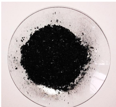
Figura 3.3 – Carvão vegetal após o pré-tratamento (secagem e cominuição).
