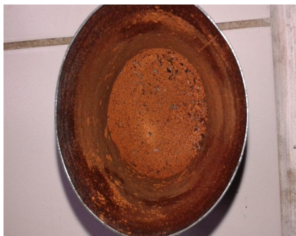
Figura 3.5 – Mistura de lama vermelha e carvão vegetal após a homogeneização.
