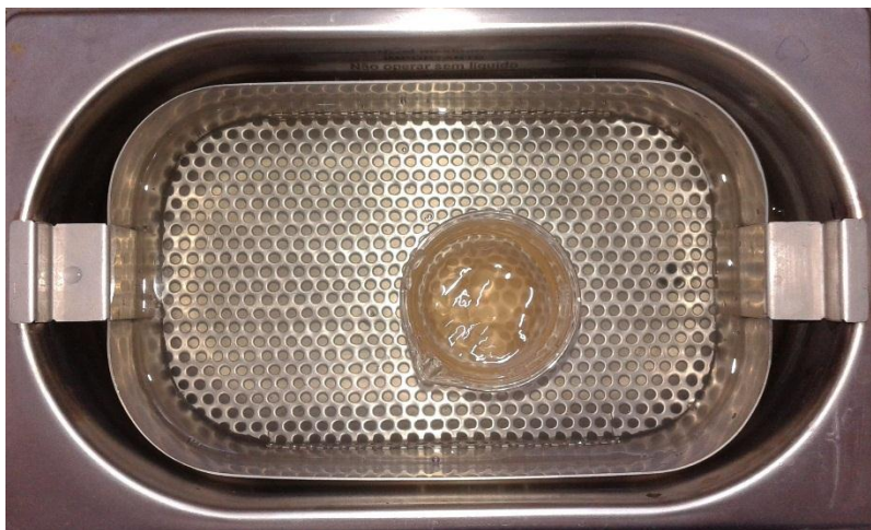
Figura 3.6 – Desagregação da mistura LV + C em banho ultrassônico.
