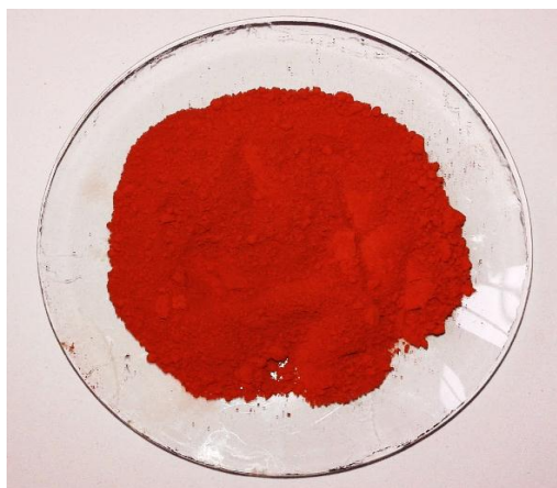
Figura 3.2 – Lama vermelha seca, moída e peneirada.
