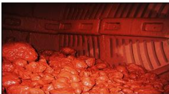
Figura 2.4 – Interior do moinho de bolas a úmido da Hydro Alunorte.
