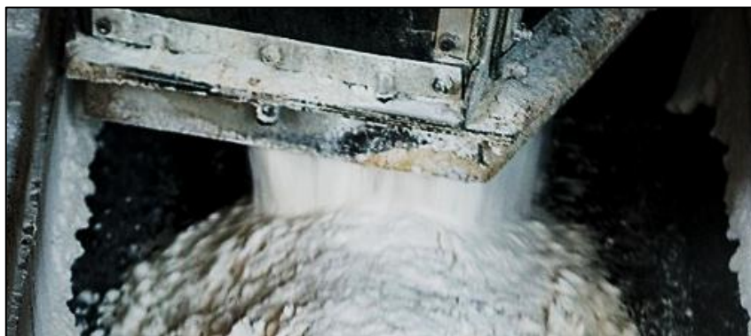
Figura 2.8 – Óxido de alumínio (alumina) obtido após o processo de calcinação.
