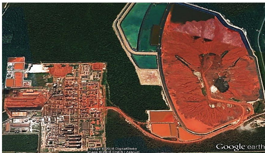
Figura 2.10 – Imagem aérea obtida pelo Google Earth da Hydro Alunorte (Barcarena-PA), em 2016, destacando o depósito de resíduos sólidos (DRS) onde é estocada a lama vermelha.
