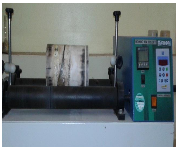
Figura 3.4 – Moinho de bolas portátil utilizado para homogeneizar a mistura.
