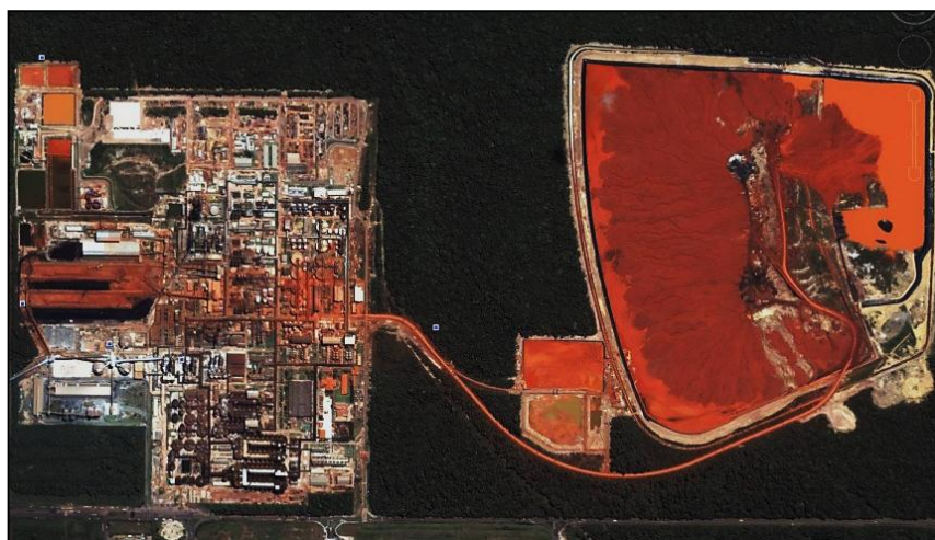
Figura 2.9 – Foto aérea da fábrica da Hydro Alunorte em Barcarena-PA destacando o depósito de resíduos sólidos (DRS) onde é estocada a lama vermelha.
