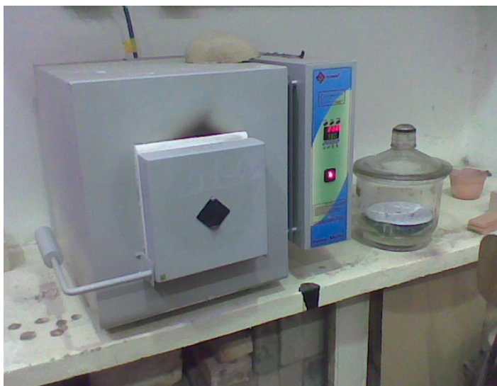
Figura 3.15 – Forno tipo mufla e dessecador utilizados para determinação de água quimicamente combinada.
