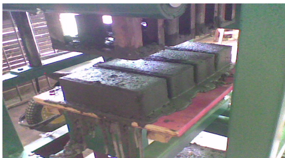
Figura 3.2 – Retirada dos blocos da prensa
